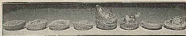
Abb. 5. Tiegelkoksproben von Bogheadkohle (a Flöz 15, Brassert), Kennelkohle (b Wilhelmine Victoria; c Lohberg), Pseudokennelkohle (d Hardenberg; e Rönsberghof; f Flöz Dünnebank, Gneisenau), Kennelschiefer (g Flöz Finefrau, Holstein), Pseudokennelschiefer (h Flöz Voß-Wasserbank, Zollverein).
