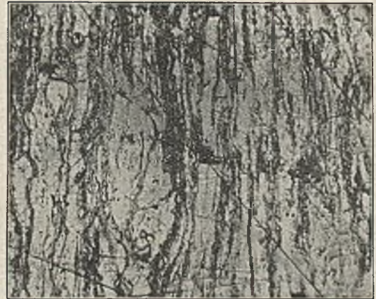
Abb. 4. Brandschiefer (Kennelschiefer) aus dem Flöz Luise der Zeche Minister Stein. Er besteht aus einzelnen Vitritteilchen, die durch aschenreiche Grundmasse verkittet sind. v = 120.
