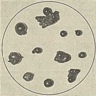
Abb. 2. Bei der Heizwertbestimmung von Kohlen mit einem Aschengehalt über 40 % erhaltene Aschenschmelzkugeln.
