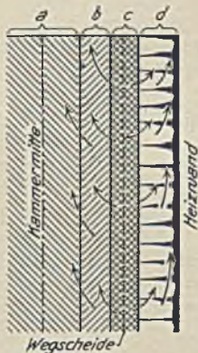
Zonen- und Strömungsbild in einem Kohlen- und Koksblock.
