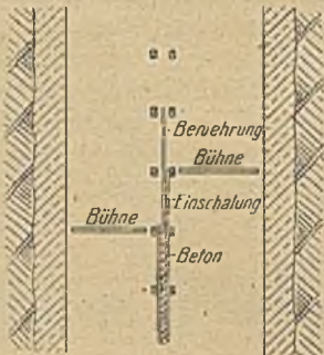
Abb. 21. Herstellung des Wetterscheiders.
