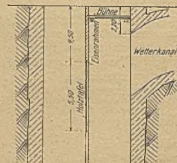
Abb. 23. Anschluß des Ausziehtrums an den Wetterkanal.
