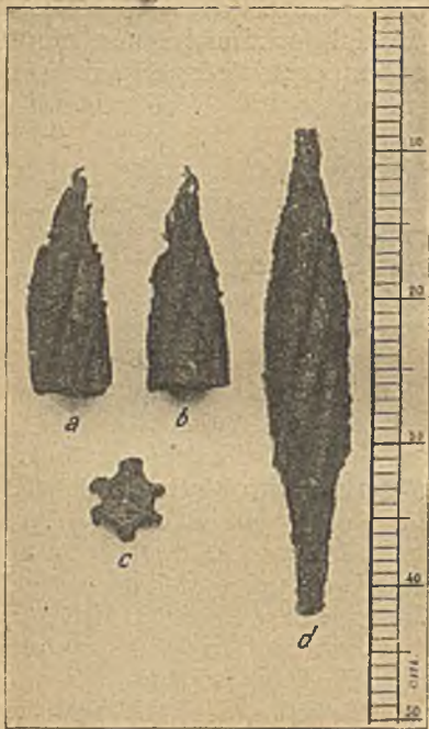
Abb. 3. Hanfseelenknoten aus einem abgelegten Förderseil der Zeche Königsborn.
