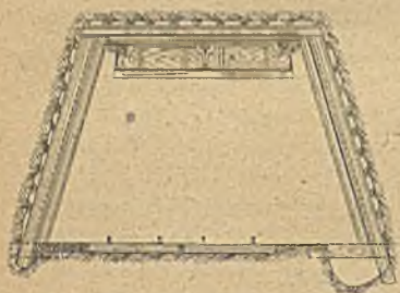
Abb. 19. Streckenquerschnitt mit eingebautem Gesteinstaubbruch von hoher Bauart.
