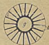
Abb. 16. Wage-rechter Schnitt durch den Einsatz der Retorte von Bostaph.
