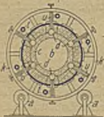
Abb. 8. Querschnitt durch die Retorte von Thomas.
