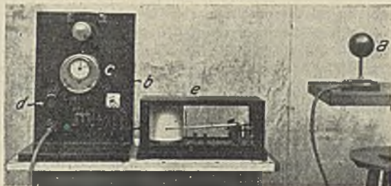
Abb. 1. Ansicht des Frigorimeters.
