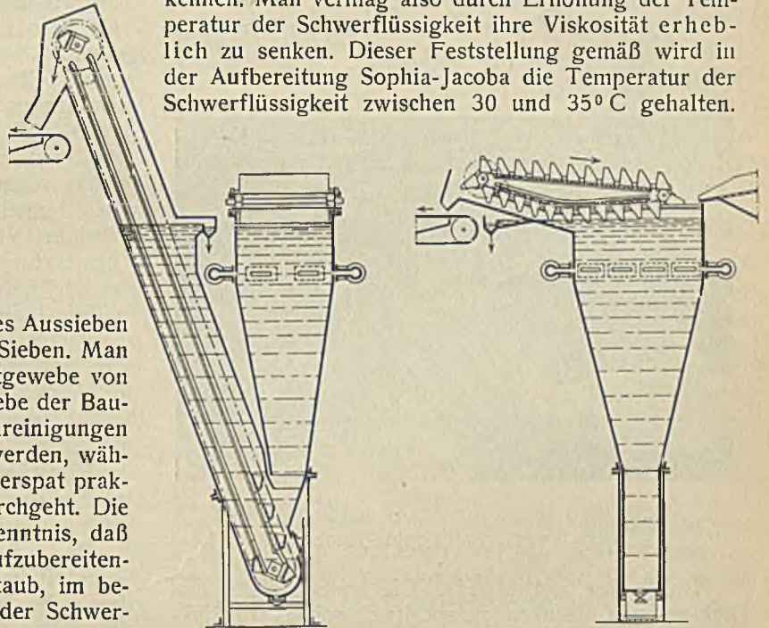
Abb. 6. Schwimm- und Sinkkasten.
