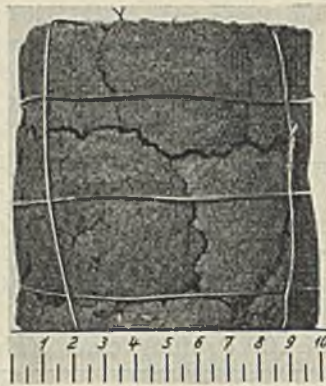
Abb. 7. Mit 6% Koksgruszusatz hergestellte Retortenkoksproben.
