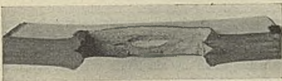
Abb. 12. Gummischiebe nach der Verwendung in der Preßform.
