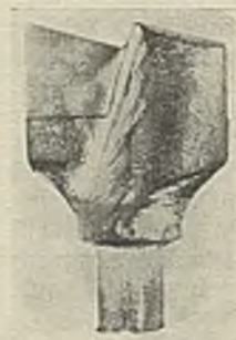
Abb. 7. Kerbschneide mit Hartmetallbesatz.
