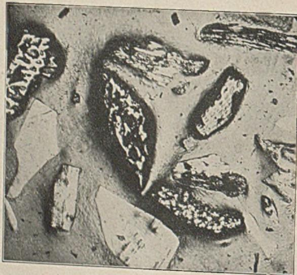
Abb. 13. Fusitreiche Gewebesiebstufe über 0,2 des Rohschlammes C.  $v=70$ .
