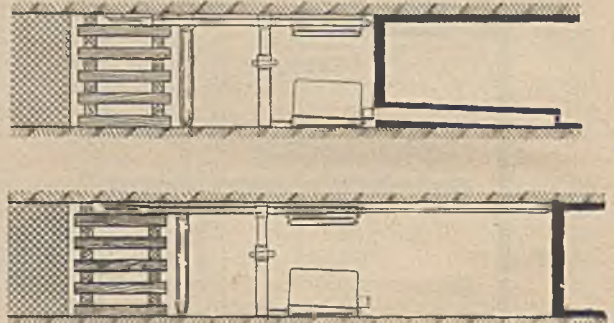
Abb. 25. Vorpfändautomat der Bergtechnik GmbH., Lünen, in Ausgangs- und Endstellung.
