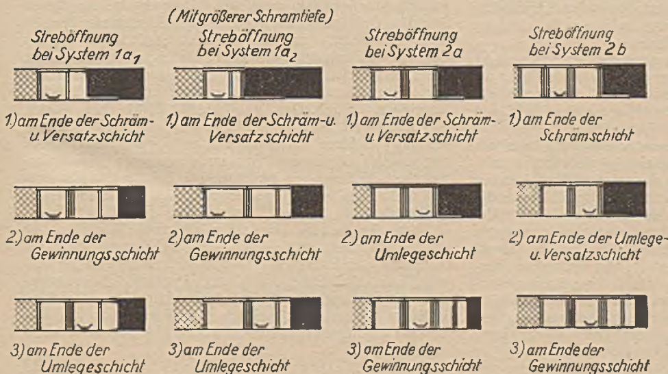
Abb. 3. Einwirkung der Reihenfolge der Betriebsvorgänge auf die Streböffnung in Schrämbetrieben.
