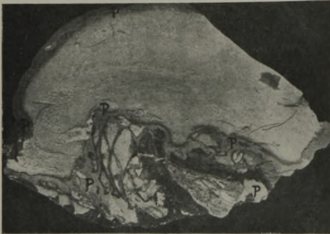
Abb. 1. Querschnitt der Knolle, oben hangender Teil, unten dolomitierter Teil. P = Pyritschicht. v = rd. 1,25.
