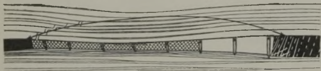
Abb. 9. Öffnung von Trennungsspalten beim Abbau von Osten nach Westen.
