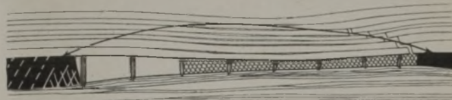
Abb. 8. Öffnung von Trennungsspalten beim Abbau von Westen nach Osten.
