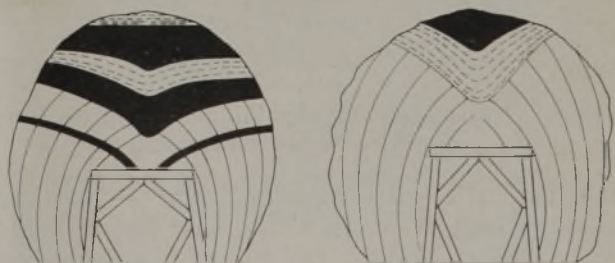
Abb. 5 und 6. Schalenförmige Ablösungen in der Trompeterschen Zone auf der Zeche General Blumenthal.
