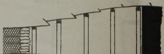
Abb. 14. Stauchungen und Überschiebungen des Hangenden.
