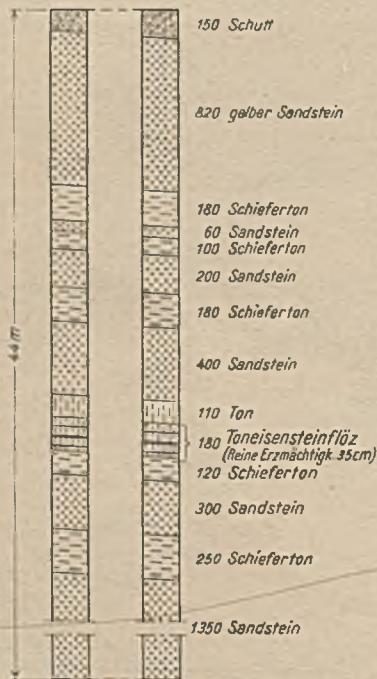
Abb. 2. Schachtprofil einer Toneisensteingrube.
