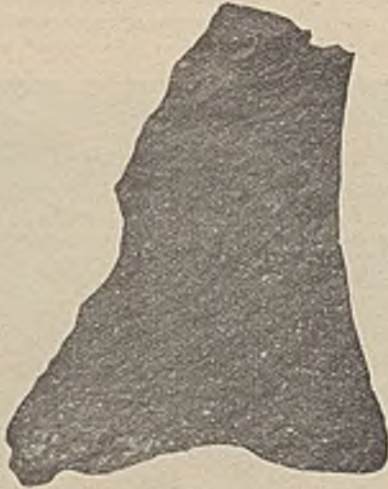
Abb. 8. Bruchfläche eines sandigen Schiefers, 2,5 \times . Wiederum sind zahlreiche Glimmerschüppchen (helle Punkte) zu erkennen. Im oberen Abschnitt des Bildes zeigt sich die Bruchfläche als stark profiliert, im unteren Abschnitt als vollkommen uneben.
