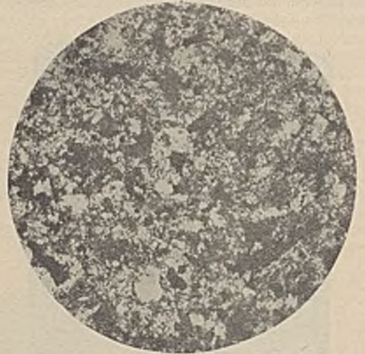
Abb. 5. Dünnschliffaufnahme eines sandigen Schiefers, 80 \times . Die weißen Flecken sind Quarzkörner, deren unregelmäßige Umrandung im einzelnen deutlich zu erkennen ist. Die kohlige bzw. bituminöse Substanz ist an der tief-schwarzen Farbe kenntlich. Die Grundmasse weist eine dunkelgraue Färbung auf.
