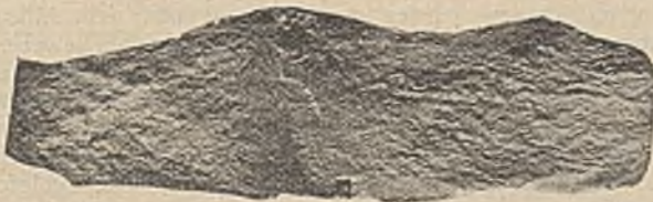
Abb. 12. Die flachmuschlige bis unebene Bruchfläche eines reinen Schiefers, 1,5 \times .
