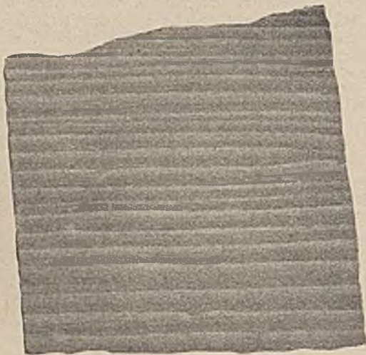
Abb. 4. Sandstreifiger Schiefer, 2,5 \times . Man kann deutlich den Wechsel von Sandlagen (helle Farbe) und mehr oder weniger sandigen »Schieferton«streifen (dunkle Farbe) unterscheiden.
