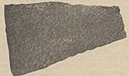
Abb. 10. Bruchfläche eines schwachsandigen Schiefers, nat. Gr. Im einzelnen sind deutlich die Unebenheiten bzw. die Ansätze zu einem muschligen Bruch zu erkennen.
