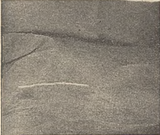
Abb. 11. Spaltfläche eines reinen Schiefers, 2,5 \times . Zum Unterschied von Abb. 9 tritt hier deutlich ihre mehr oder weniger große Ebenmäßigkeit bzw. an den vorhandenen Unebenheiten die weitaus ausgeglichener Form in Erscheinung. Die Ritzprobe ergibt einen vollkommen ebenen, gleichmäßigen und glänzenden Strich (weiße Farbe).
