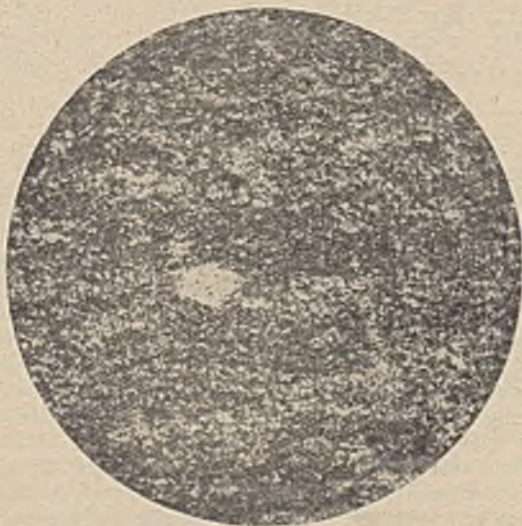
Abb. 6. Dünnschliffaufnahme eines schwach-sandigen Schiefers, 80 \times . In der Mitte der Aufnahme tritt deutlich ein Quarzkorn hervor (weiße Farbe). Der Rest stellt die mehr oder weniger feinkörnige Grundmasse dar, in der vereinzelt noch kleine Quarzkörner zu sehen sind.
