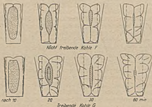
Abb. 2. Schnitt durch die Waldenburger Muffelprobe.
