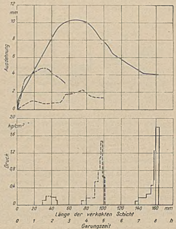
Abb. 15. Druck auf die Kohlenseite, Ausdehnung und Schrumpfung bei verschiedener Schichtlänge. Kohle G 7, Raumgewicht 1,0.
