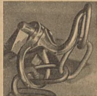
Abb. 3. Einhängen des lockeren Kettenendes in den Haken durch den nach unten gedrehten Ring.
