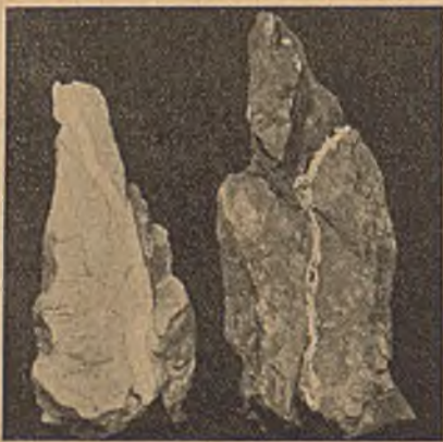
Abb. 8. Ausfüllung von Rissen durch Einpressen von Zementmilch.
