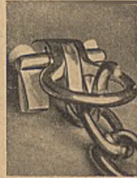
Abb. 2. Sicherheitskupplung von vorn gesehen.
