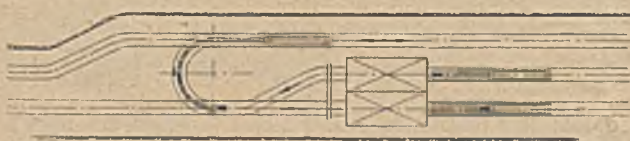
Abb. 2. Kurvenzieher mit beiderseitiger Durchfahrtsmöglichkeit.
