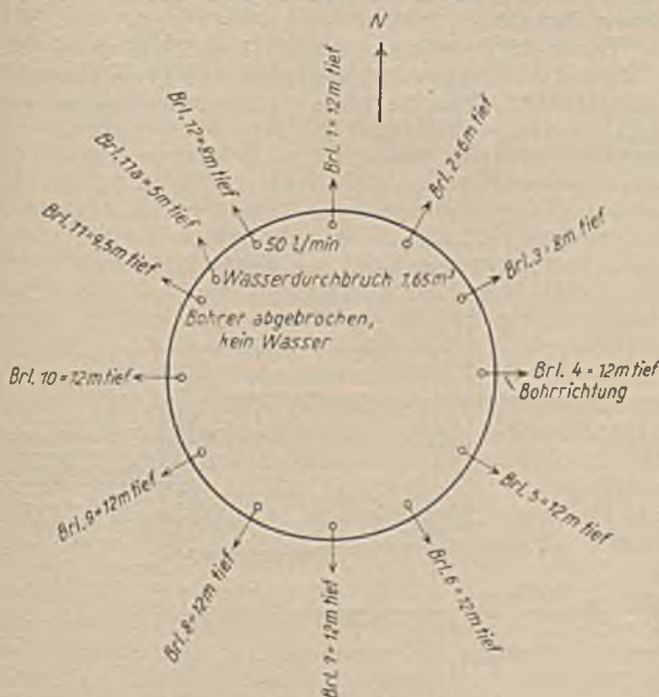
Abb. 6. Die Schachtsohle bei 599,7 m Teufe im Augenblick des Wassereintrichs.
