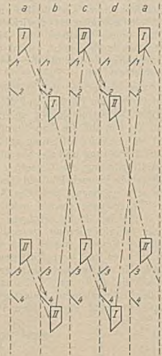
Abb. 7. Umsetzverfahren für Gefäßförderungen zum gleichzeitigen Fördern und Einhängen (aus der Patentanmeldung 35a, 9/03, S. 114 519).
