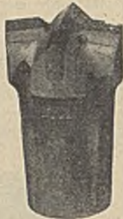
Abb. 5. Hartmetallschlagbohrer mit Innengewinde in verbesserter Ausführung.
