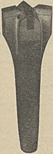
Abb. 8. Hartmetallschlagbohrer mit Konus in der heutigen Form.
