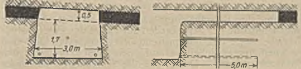
Abb. 3. Schießen mit 3 Hebschüssen (Fannyflöz, Kopfstrecke unter dem 5. Horizont.)
