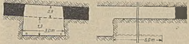
Abb. 2. Schießen mit 2 Hebschüssen (V. Flöz, VI. Grundstrecke südl. Tiefbau.)
