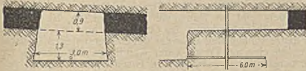
Abb. 1. Schießen mit einem Hebschuß (Hugoflöz. VII. Grundstrecke südl. Tiefbau.)
