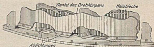
Abb. 4. Verbesserte Abdichtung des Drehkörpers beim Ljungström-Luftvorwärmer.
