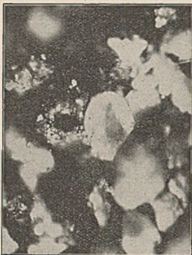
Abb. 1. Im Schmelzfluß kugelförmig vereinigte Aschenteilchen. v = 50 .
