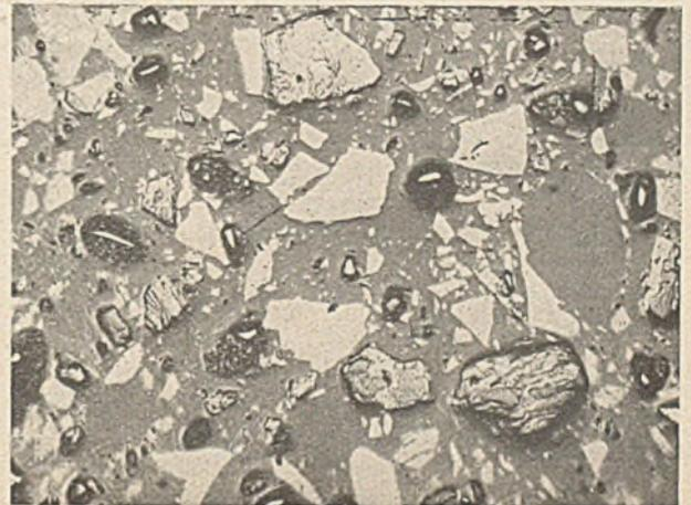
Abb. 6. Glanzkohle, Mattkohle und Faserkohle. Korngröße  $< 88 \mu$ . Reliefschliff.  $v = 150$ .
