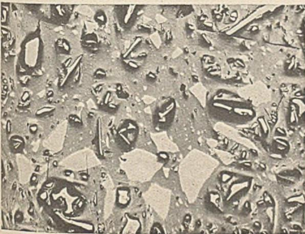
Abb. 5. Glanzkohle und Faserkohle. Korngröße  $< 88 \mu$ . Reliefschliff.  $v = 150$ .
