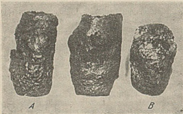
Abb. 1. Gleichmäßig gute Koksproben aus Magerkohlenvitrit (A), Fettkohlenvitrit und Gaskohlenvitrit (B).
