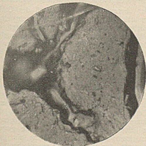
Abb. 5. Kennelkohle nach 90 s Verkokungsdauer, im Gefüge noch wenig verändert.
