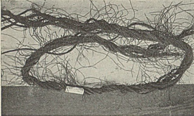
Abb. 2. Bruchende des Seils.
