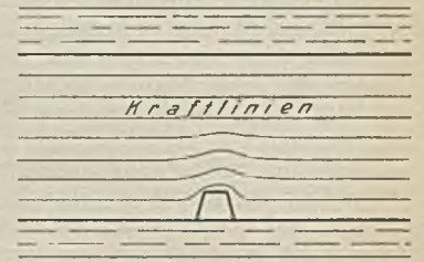
Abb. 6a. Starke Spannungen in einer einzelnen Strecke.
