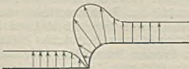
Abb. 1. Verteilung der Randspannungen in der Nähe eines Kerbs (an der vorspringenden Ecke wird die Spannung Null).
