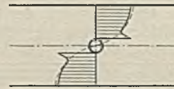
Abb. 8c. Stab mit kleiner Querbohrung.
