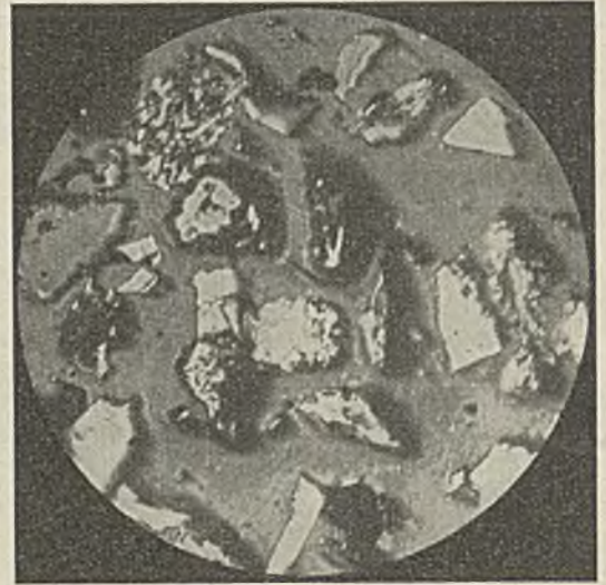
Abb. 10. Siebstufe 75–60 \mu der Zeche B. v = 150.
