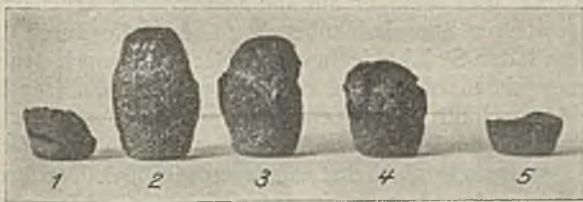
1 Rohstaub, 2 120–88 \mu , 3 88–75 \mu , 4 75–60 \mu , 5 < 60 \mu . Abb. 13. Tiegelkoksproben der Zeche A.
