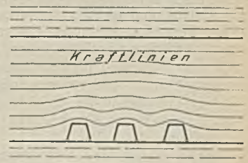
Abb. 6b. Gegenseitig entlastende Wirkung von Parallelstrecken.
