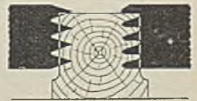
Abb. 6. Eingriff bei abgenutzten Spurlatten.
