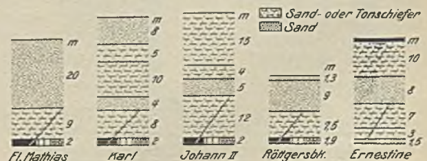
Abb. 13. Hangendzusammensetzung von Flözen mit gleichen Druckerscheinungen.
