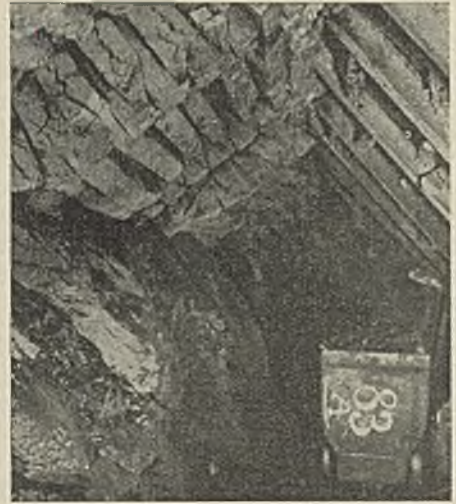
Abb. 15. Um 30–50% zusammengedrückter Holzpfiler.
