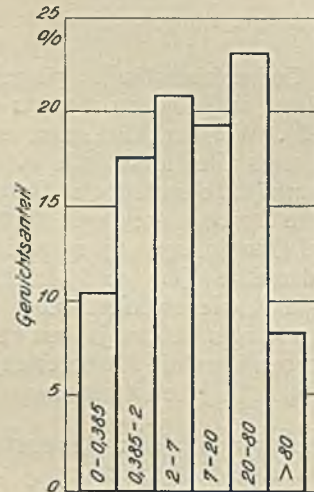
Abb. 1. Darstellung der Kornzusammensetzung in Fraktionen.
