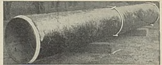
Abb. 3. Ansicht der Lutte mit neuartigem Wärmeschutz.
