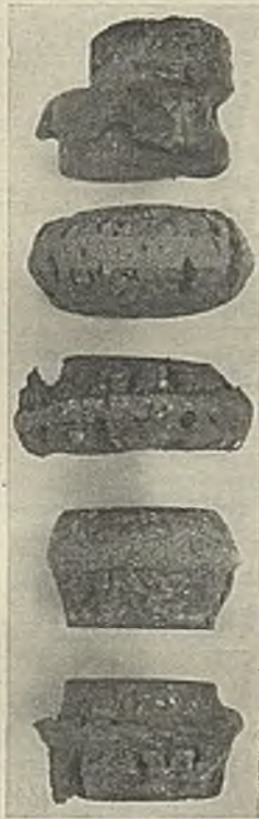
Abb. 7. Silikasteinproben mit Mörtelfugen nach der Prüfung der Druck-Feuerbeständigkeit.
