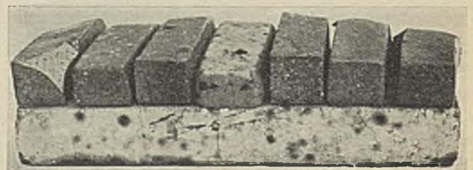
Abb. 6. Ergebnisse der Dauerglühung von feuerfesten Mörteln (6 h bei 1500° gegläht).
