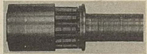
Abb. 1. Verschleiß eines Walzenlagers nach 153 Laufstunden; Rollen genutet und an den Enden um 0,2 mm dünner als in der Mitte.
