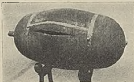
Abb. 5. Mit legiertem Sonderschweißdraht geschweißter Kessel aus Flußstahl II, durch Wasserdruck zerstört.
