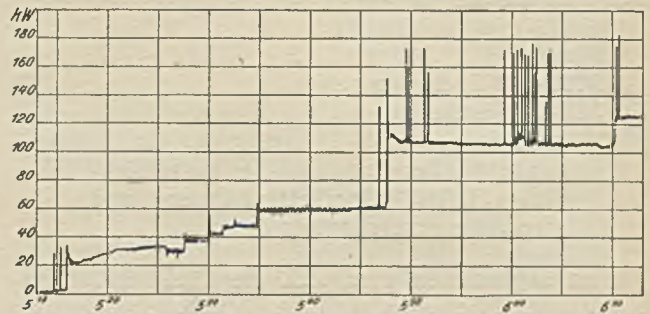
Abb. 11. Leistungsverlauf beim Anfahren der Sieberei (ausschließlich Rohkohlenturm).
