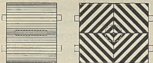
Abb. 7. Größenvergleich zwischen Geradzahnmotor (links) und Pfeilradmotor (rechts) von gleicher Nennleistung.
