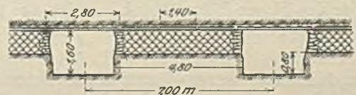
Abb. 2. Blindortbetrieb im Flöz Wilhelm (Flözmächtigkeit 1,10 m).
