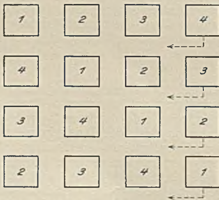
Abb. 1. Rückwärtsschalten bei der trocknen Gasreinigung.
