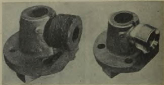
Abb. 12. Fertig aufgeschweißter und bearbeiteter Rotgußstutzen.
