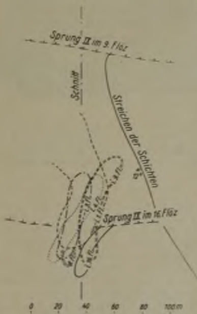
Abb. 2. Kohlenriegel im Hangenzuge, Bahnschacht (Aufriß).
