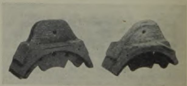
Abb. 4. Antriebsecken (Polygonecken), verschlissen (rechts) und aufgeschweißt.
