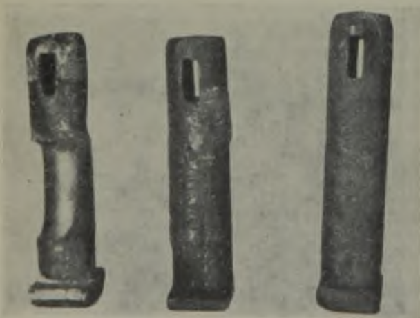
Abb. 2. Eimerkettenbolzen, verschlissen, aufgeschweißt und abgeschliffen.
