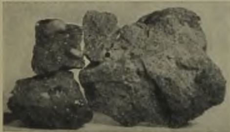
Abb. 8. Rechts: Kohlenriegel feinkörnig (unten, dunkler) grenzt an stark mit Ankerit durchsetzten Sandstein (oben, heller) mit unregelmäßig gezackten Umrissen. Links: Sandsteinartiger Kohlenriegel mit vereinzelt größeren Quarzgeröllen und Kohlenbruchstücken. Berthaschacht bei Fellhammer.
