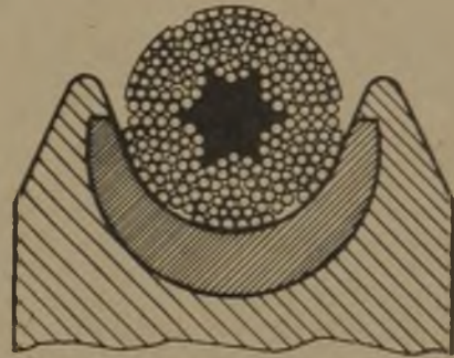
Abb. 9. Anpassung des Seiles an die Rille (und des Leichtmetallfutters dieser an das Seil).
