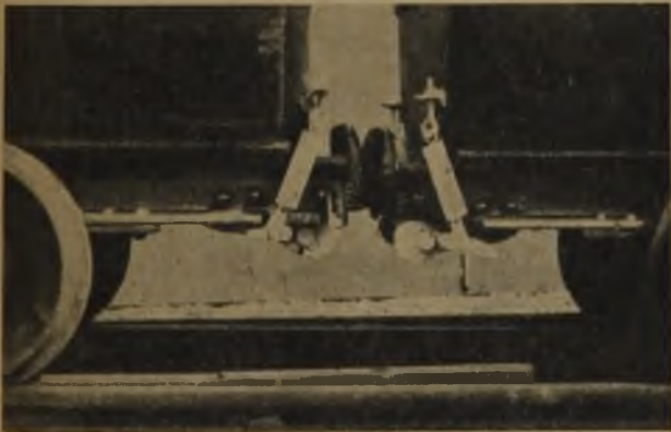
Abb. 13. Brüninghaus-Müthing-Kupplung in Ruhestellung.
