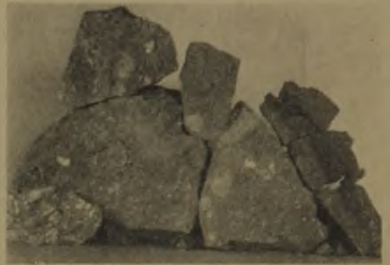
Abb. 12. Braunlichgraues Riegelgestein mit Eruptivgesteinsbrocken und Quarzgeröllen. Rechts: z. T. in Roteisen umgewandelte Linse von Toneisenstein (dunkel) mit von Spat durchsetzter, anthrazitischer Kohle (heller); Senkschacht etwa 500 m unter dem Gipfel des Neuhaus Schloßbergs (v ≈ 1/7).
