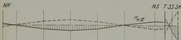
Abb. 10. Schwingungsbild 3. Grades für die Korbstellung A. Die Ausschläge sind den Halbmessern entsprechend umgerechnet und über den wirklichen Seillängen aufgetragen worden. Bei T beachte man zwei verschiedene Ausschläge.
