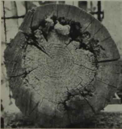
Abb. 4. Entwicklung einer Faulzone unter der Oberfläche.
