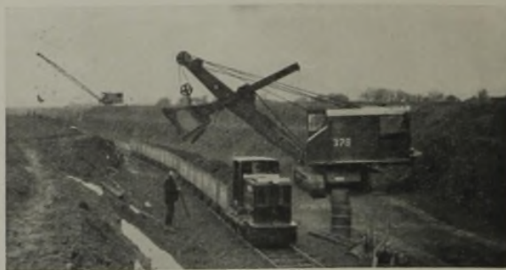
Abb. 3. Tagebau auf dem Northampton-Flöz bei Stamford mit 1,5 m Abraum- und 2,5 m Erzmächtigkeit.
