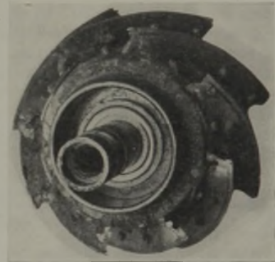
Abb. 14. Messerkorb der Wedag-Schleuder (nach 45000 t Durchsatz).
