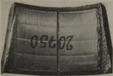
Abb. 10. V2A-Sieb mit zu breiten »Streifen«.
